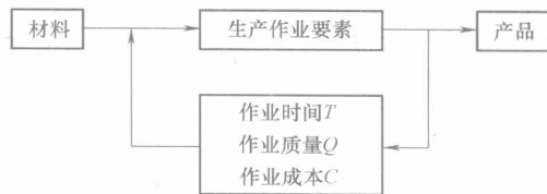
图 1-6 生产作业系统构成简图
