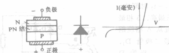
图 1-2 整流二极管的结构、符号、伏安特性
