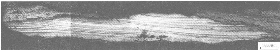
图 3 剑 MFe2 横截面显微图，显示折叠锻打痕迹
