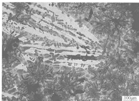
图6 鼎 MFe3 的灰口铁组织
