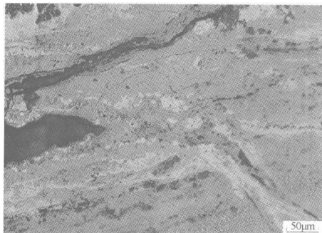
图9 剑 MFe4 锈蚀中铁素体 + 珠光体组织痕迹
