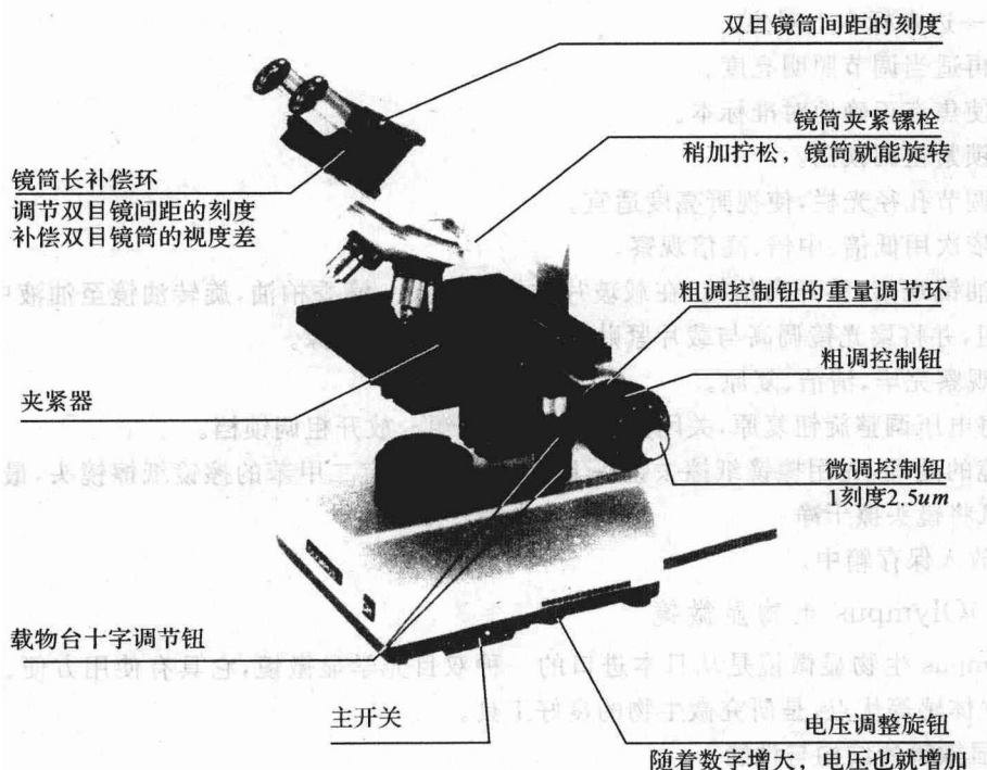
图 1-7 Olympus 显微镜的结构示意图 2
