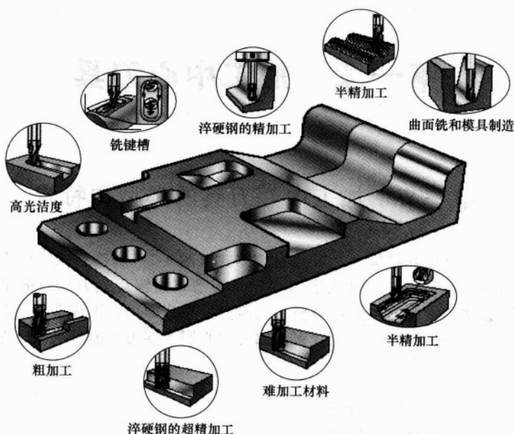
图 1-3 加工中心用部分铣刀的形状及适用范围
