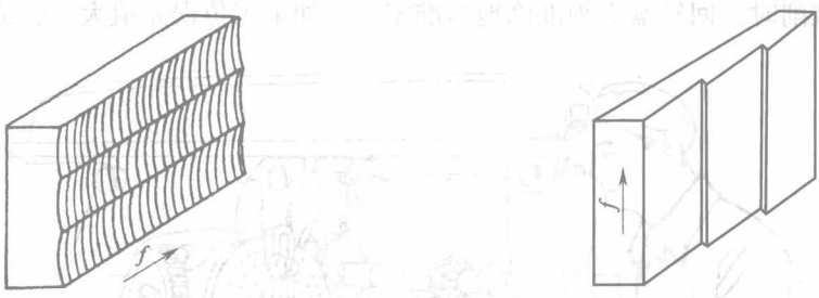
图 1—15 回转盘零位误差对铣削的影响（二） 图 1—16 回转盘零位误差对铣削的影响（三）
