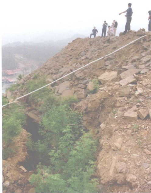
2007 年 8 月，技术人员在房山对因 开挖坡脚造成的山体滑坡进行勘查
