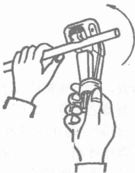
图 1.3 铜管切割加工
