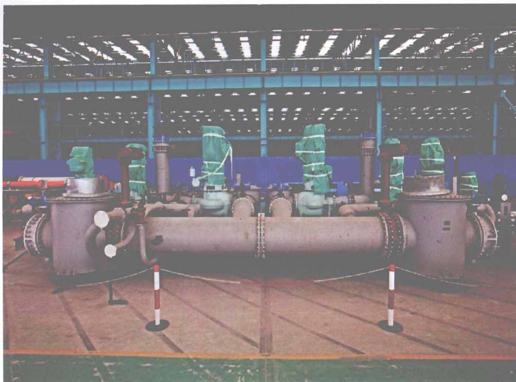
机舱海水总管大型组合单元
