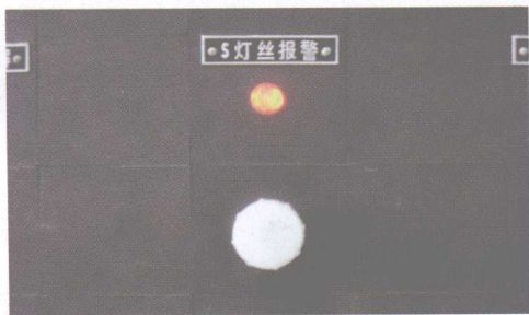
图 1-1 进站信号机断丝报警的故障现象
