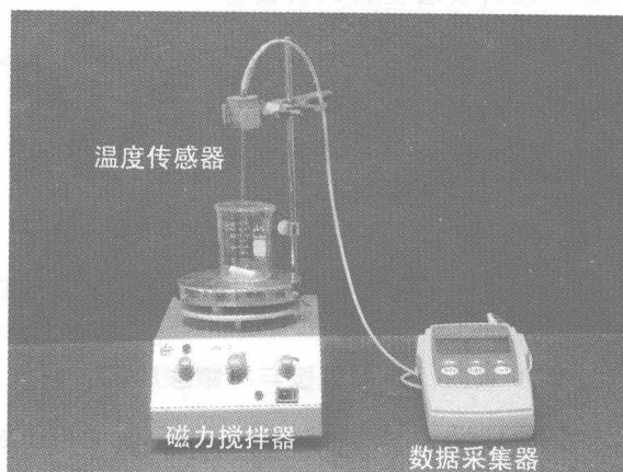
图 1-1 锌粉与硫酸铜溶液反应的实验装置图
