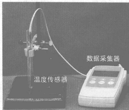
图 1-2 测定无水 \text{CuSO}_4 水化热的实验装置
