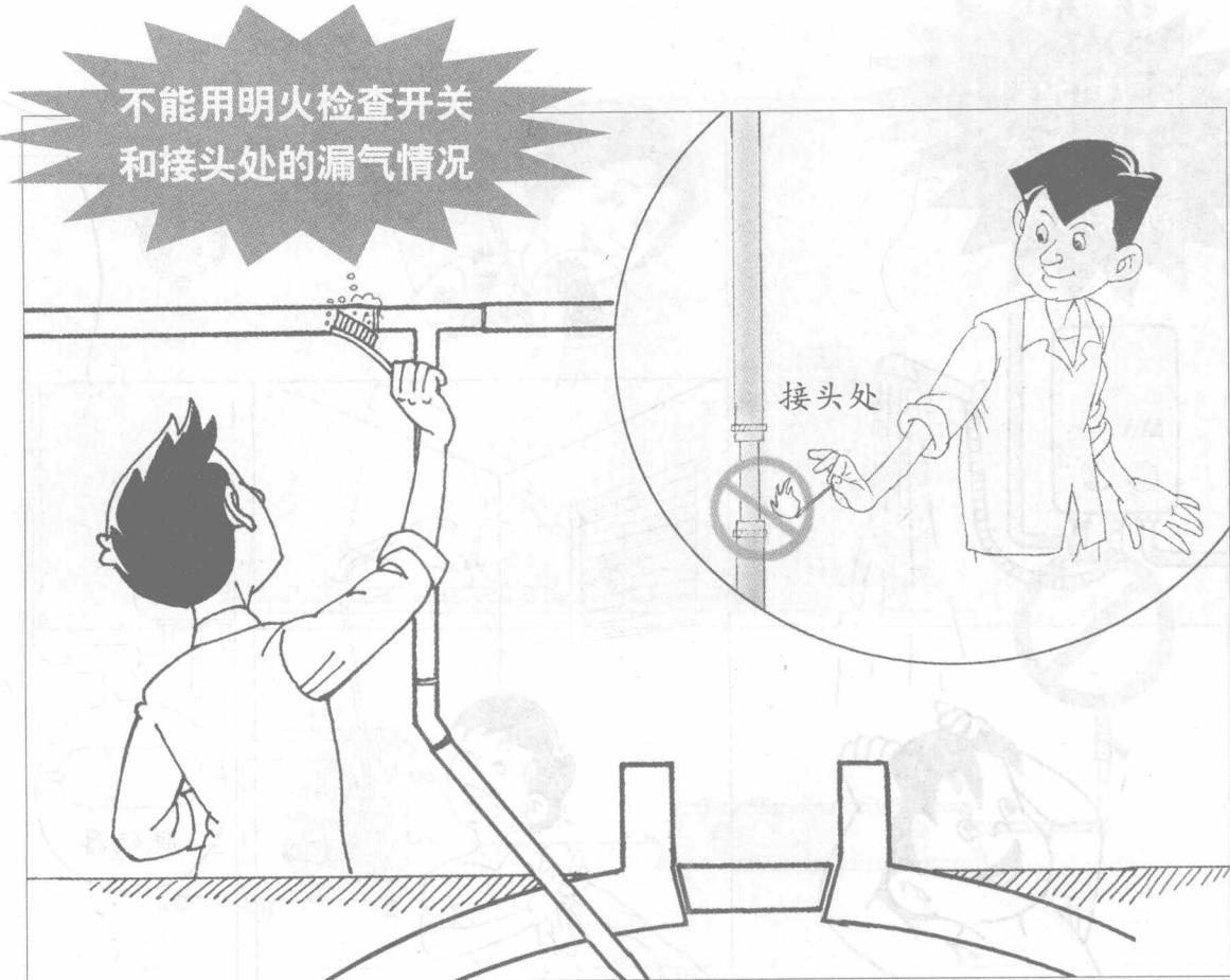
沼气使用前要緊固各个接头处，先接通气源，用肥皂水检查各接头处、开关是否漏气现象。严禁用明火检查各处接头、开关的漏气情况。
