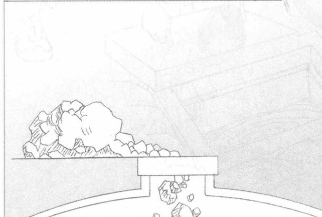
沼气池建成后，要经技术人员试水、试压，不漏水、不漏气，方可投料运行。
