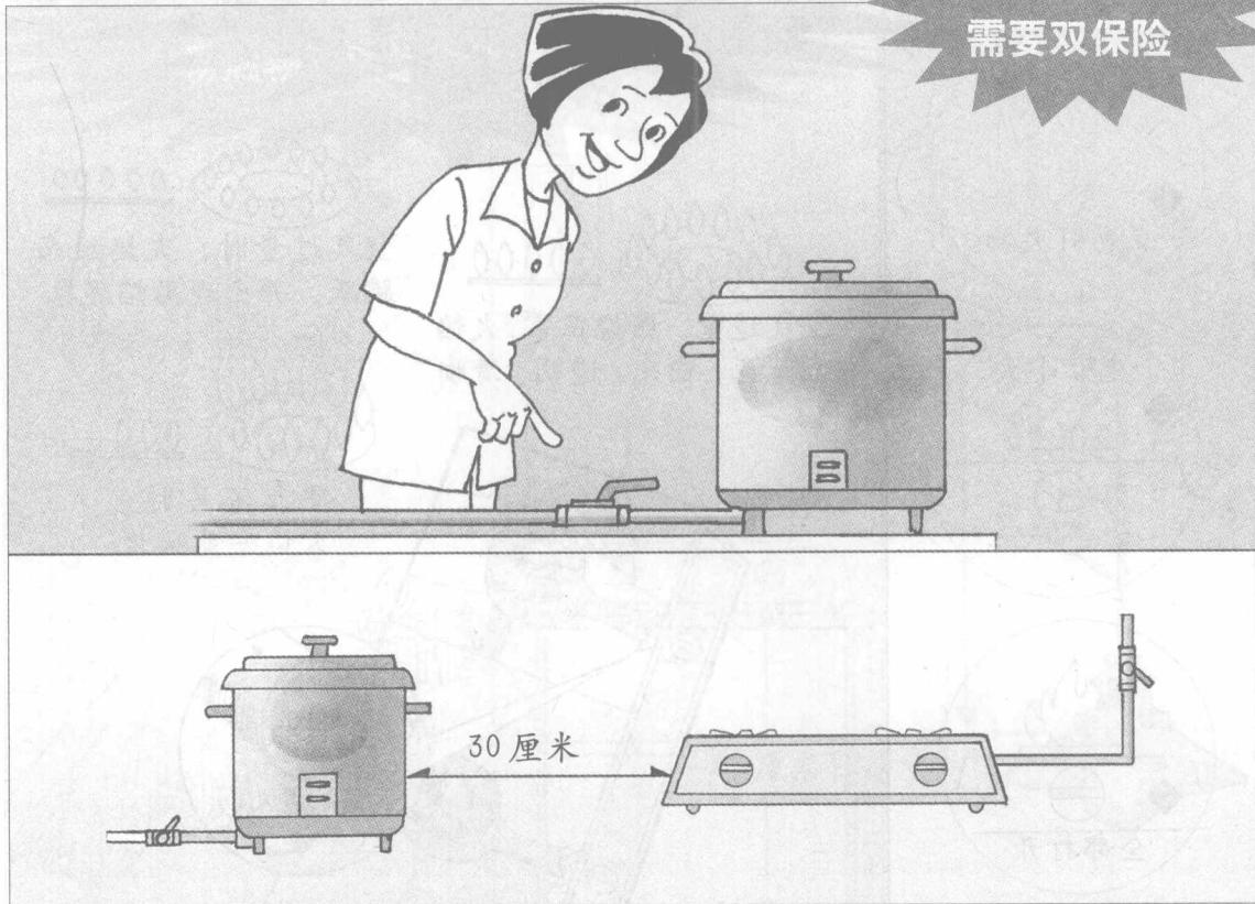
沼气饭锅安装在离沼气灶30厘米左右的地方。沼气饭锅一定要接入一个单独的控制开关，饭锅阀关闭后，同时关闭管路上的控制开关。
