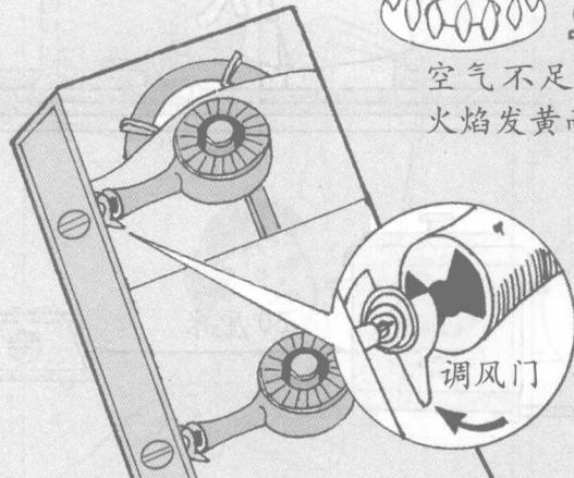
用引火物点沼气灶时，应先点燃引火物，再开开关，先开小一点，待点然后，才全部打开，以防沼气放出过多烧及身体。沼气灶燃烧不正常时，应调节风门控制。
