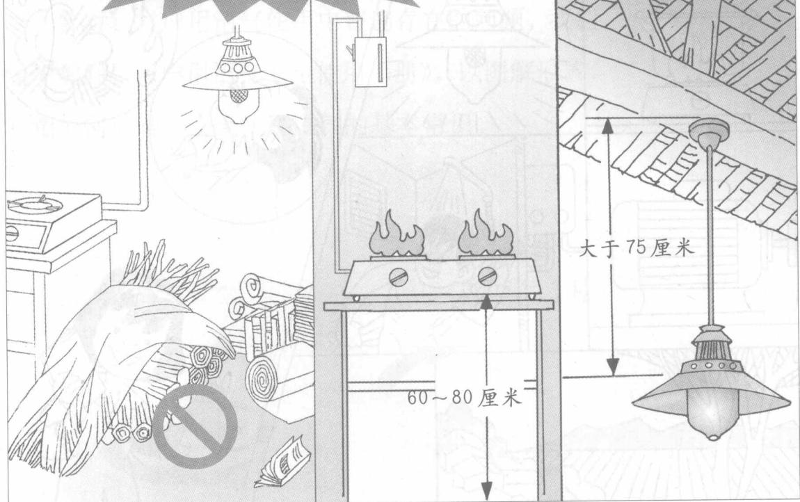
沼气灯、灶具要正确安装，调节好风门。沼气灶具离墙 15 厘米。严禁在沼气灯、灶具和输气管道旁堆放柴草、纸张等易燃物品。
