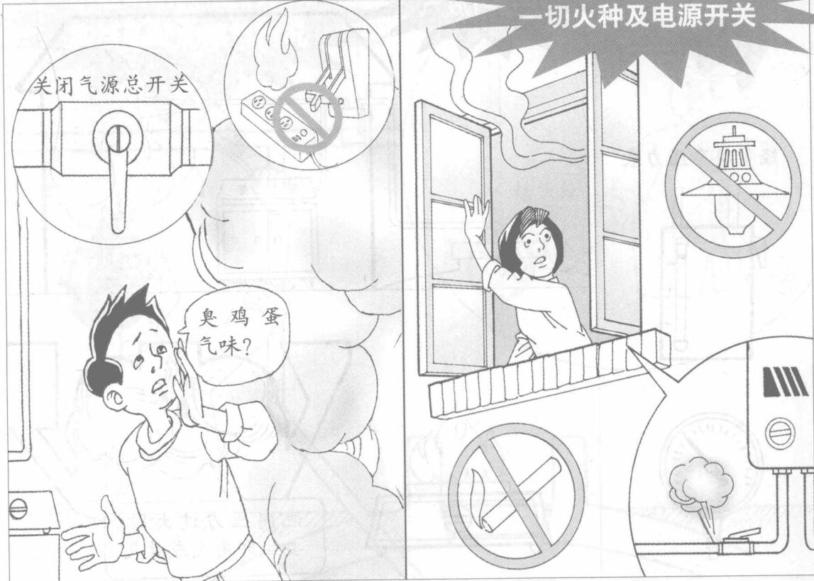
如发现漏气（室内能闻到臭鸡蛋气味），应立即关闭气源总开关，并开门通风。此时，室内严禁使用一切火种及电源开关，以防发生火灾。
