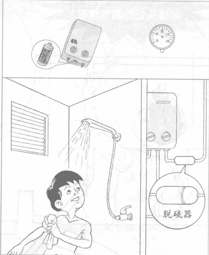
沼气热水器必须安装在洗澡间外，而且一定要安装脱硫器。如果沼气热水器点不着火，要检查水压、电池或请专业人员维修。
