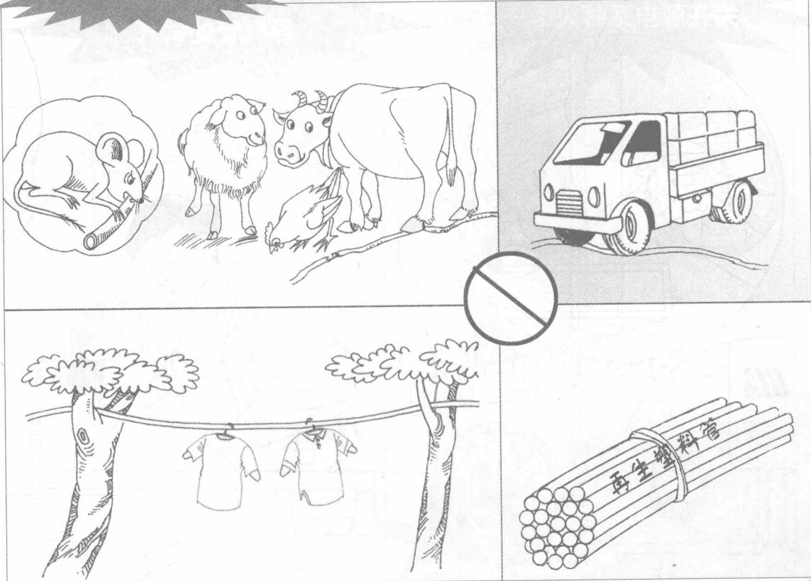
沼气输气管不能使用再生塑料管。室外管要防止被禽畜损伤、车辆压破和冻裂，不得在室外管上晾晒衣物。
