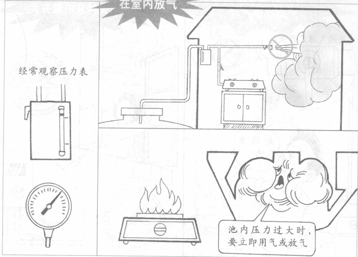
要经常观察压力表的变化，压力大于8千帕时，要立即用气或放气。在沼气池输气管室外开关处放气。严禁在室内和日光温室内放气，以防引起爆炸和使人窒息。
