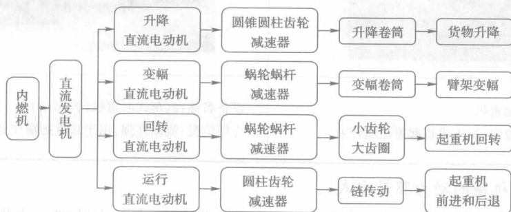
图 1-1-2 内燃机—电力驱动动力转换及驱动方框图
