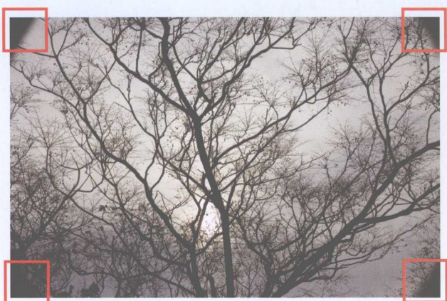
遮光罩角度太小产生暗角的情形
