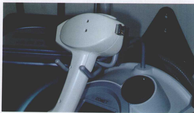
图 1-5 另一例半导体激光器，半导体配置在手具上，该配置使得能更直接地应用激光。但是高电压和激光冷却系统也必须连接在手具上，使传输带更粗大
