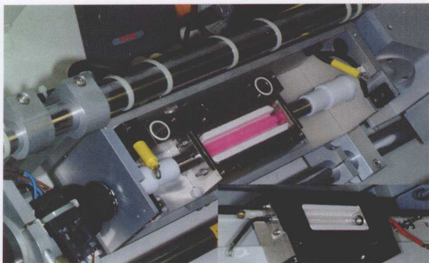
图 1-3 红宝石激光器附加高电压的红宝石棒。闪光灯部件靠近红宝石棒，通常安装在闪光灯的顶部，反射镜使红宝石棒受激发
