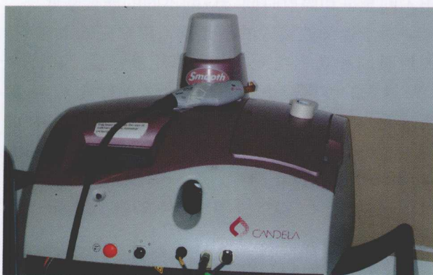
图 1-4 半导体激光，激光被耦合进连接手具的光纤中
