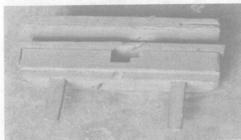
图2 木工用具：槽刨 təu 31 pau 22 （反面）
