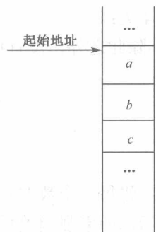
图 1-3 线性表的顺序存储示意图
