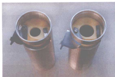
彩图 3-21 玉米用漏斗 (右侧, 直径为 40mm)
