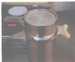
彩图 3-22 测定玉米容重 时排气砣放在插板上
