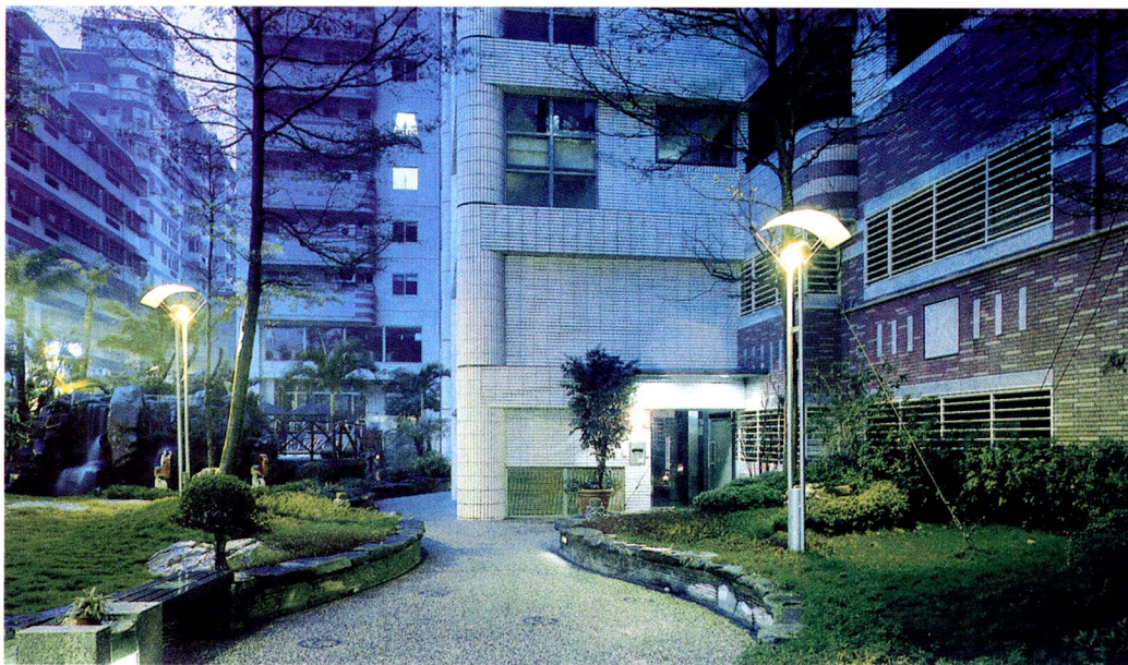
■图 8-26 庭园高灯、草坪灯、座椅嵌灯共同形成了庭园道路的照明景观。
