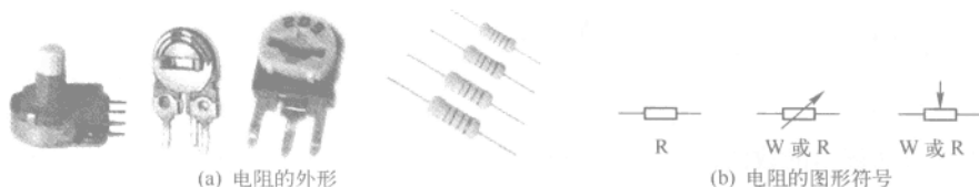
图 1.1 电阻的外形及图形符号
