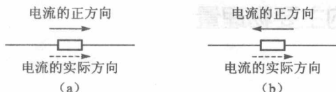
图 1-5 电流的方向 (a) I > 0 ; (b) I < 0
