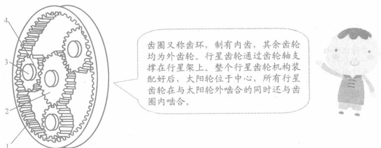
图 1-14 单排行星齿轮机构
