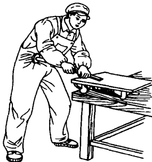
图 1.16 平面刮刀的挺刮法
