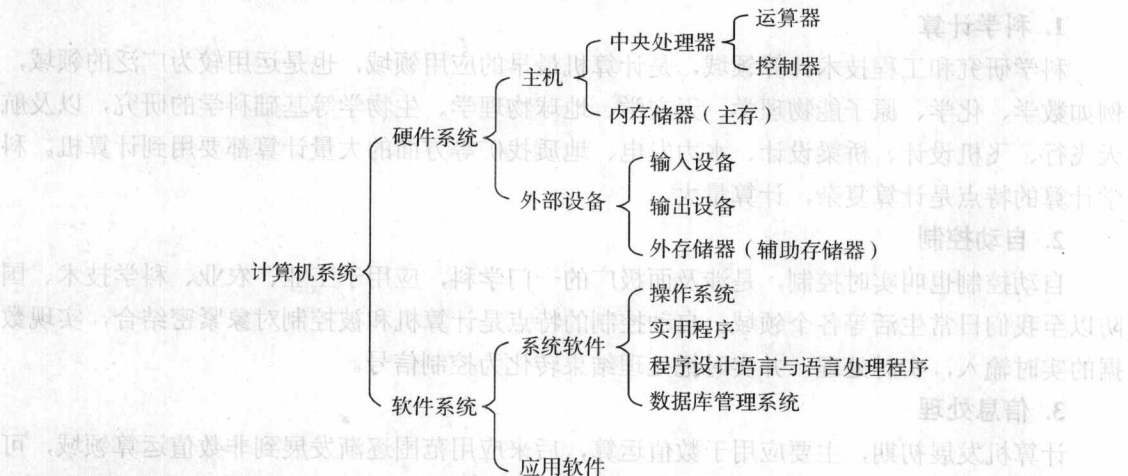
图 1.3.1 计算机系统组成结构
