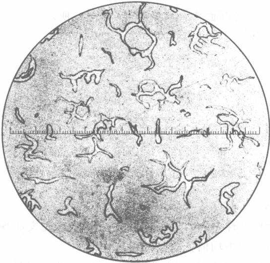
图 3 割线法测量示意图,测得数值为 14 格(14%)
