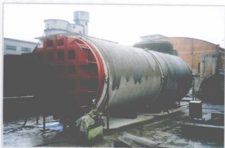
PCCP铠装接头试 验在无锡华毅管道公 司进行
