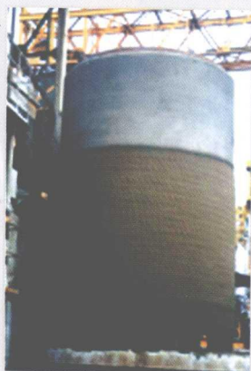
PCCP砂浆保护层辊射
