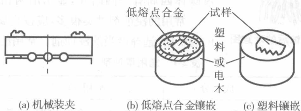
图 2-1 金相试样的镶嵌和装夹方法
