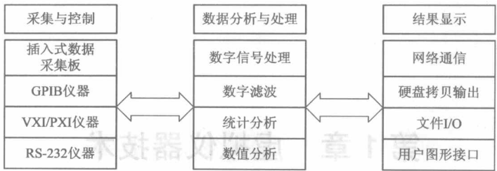
图 1-1 虚拟仪器的内部功能划分
