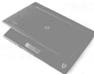
碳纤维的缺点是成本较高，成型和着色也相对较难。此外，碳纤维机壳还有一个缺点，就是如果接地不好，会有轻微的漏电感，因此需要在其碳纤维机壳上覆盖一层绝缘涂层。
