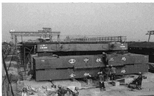
图 6 先张法 32 m 箱梁试验
