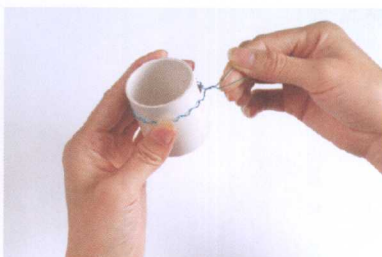
③ 将弯曲的铁丝绕在套筒上，首尾相交，缠紧。
