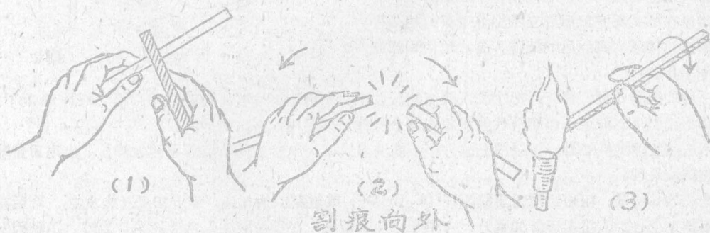
图 4 玻璃管的切斷
