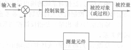
图 1-6 闭环控制系统原理框图
