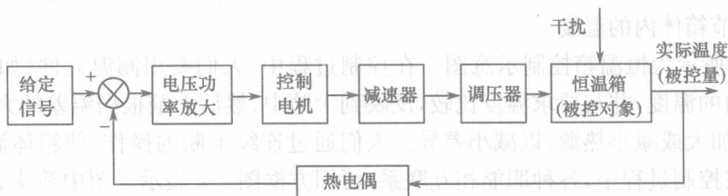
图 1-4 恒温箱自动控制信号流程方框图
