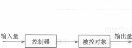
图 1-8 开环控制系统原理框图
