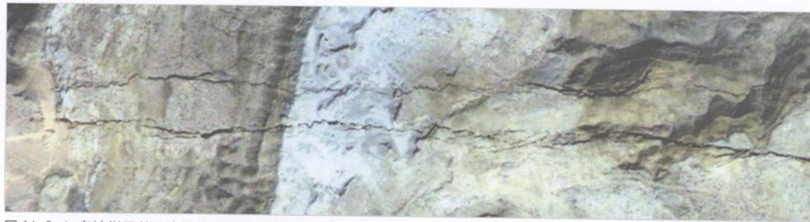
图 14-3-4 乌达煤田井田边界特大煤柱燃烧裂隙影像
