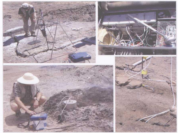
图 10-4-3 内蒙古乌达矿区 8 号火区有害气体现场测量
