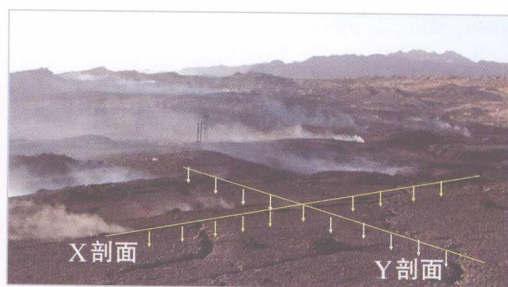
图 10-1-2 近地表土壤接触式测量方法示意图
