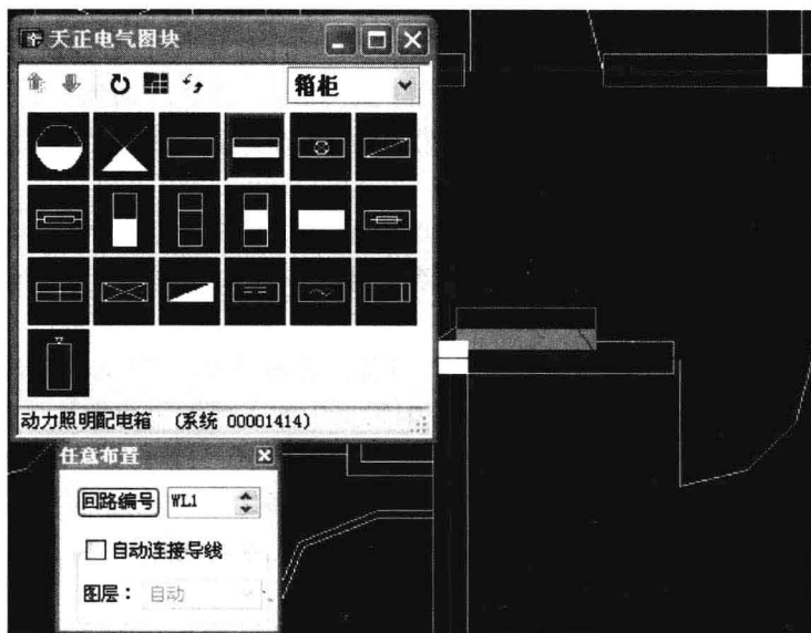
图 2-6 用【任意布置】命令布置配电箱
