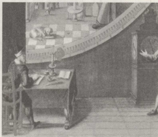
第谷在维文岛上的天文台里工作（1587）。巨大的象限仪用来测量天体的高度，那两个第谷称为“绝对精确”的钟用来定时
