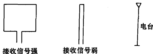
图 1.1-7 方框型天线的接收方向
