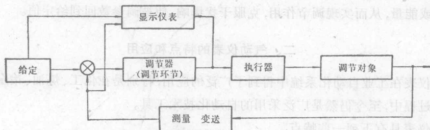
图 1-1 自动调节系统基本组成方块图
