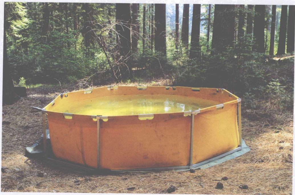
8. 火场临时储水池
