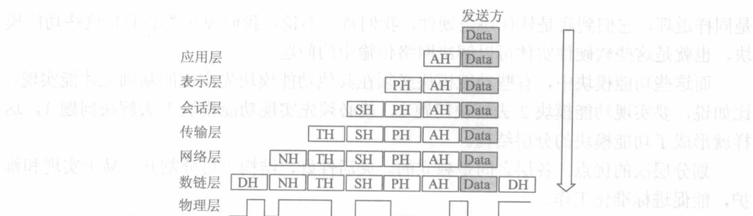
图 1.4 源主机数据封装过程
