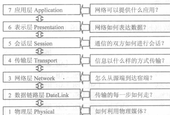
图 1.3 OSI/RM 模型的 7 层结构
