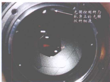
垂直方向上观看镜头中的光圈
