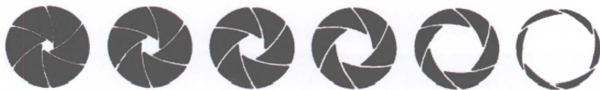
图中从左至右口径不断增大, 但在镜头中相对应的光圈数值则逐渐变小
