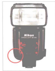
▲ 位于 Nikon SB-900 上的“传感器”即亮度测量传感器
