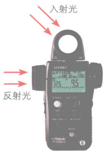
▲ Sekonic DUALMASTER L758R 同时拥有入射式与反射式测光功能的手持型测光表
