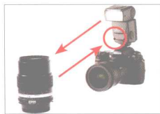
▲ 闪光在灯头射出后，被被摄物反射，一部分进入镜头被拍摄，另一部分进入“传感器”之中，用来计算闪光输出量
