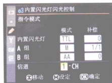
▲Nikon D300 的内置闪光灯，已拥有 i-TTL 先进无线闪光灯系统的 MASTER 主体闪光灯功能，最多能同时控制两组（无限支数）的离机 i-TTL REMOTE 遥控闪光灯的输出变化
