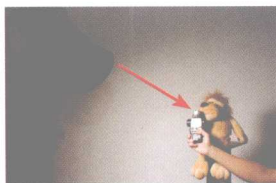
▲入射式测光的测光部件(白色半球)需要向着光源
