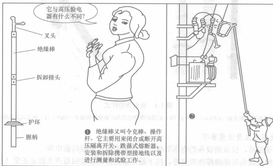
图 1-3 绝缘棒的使用
