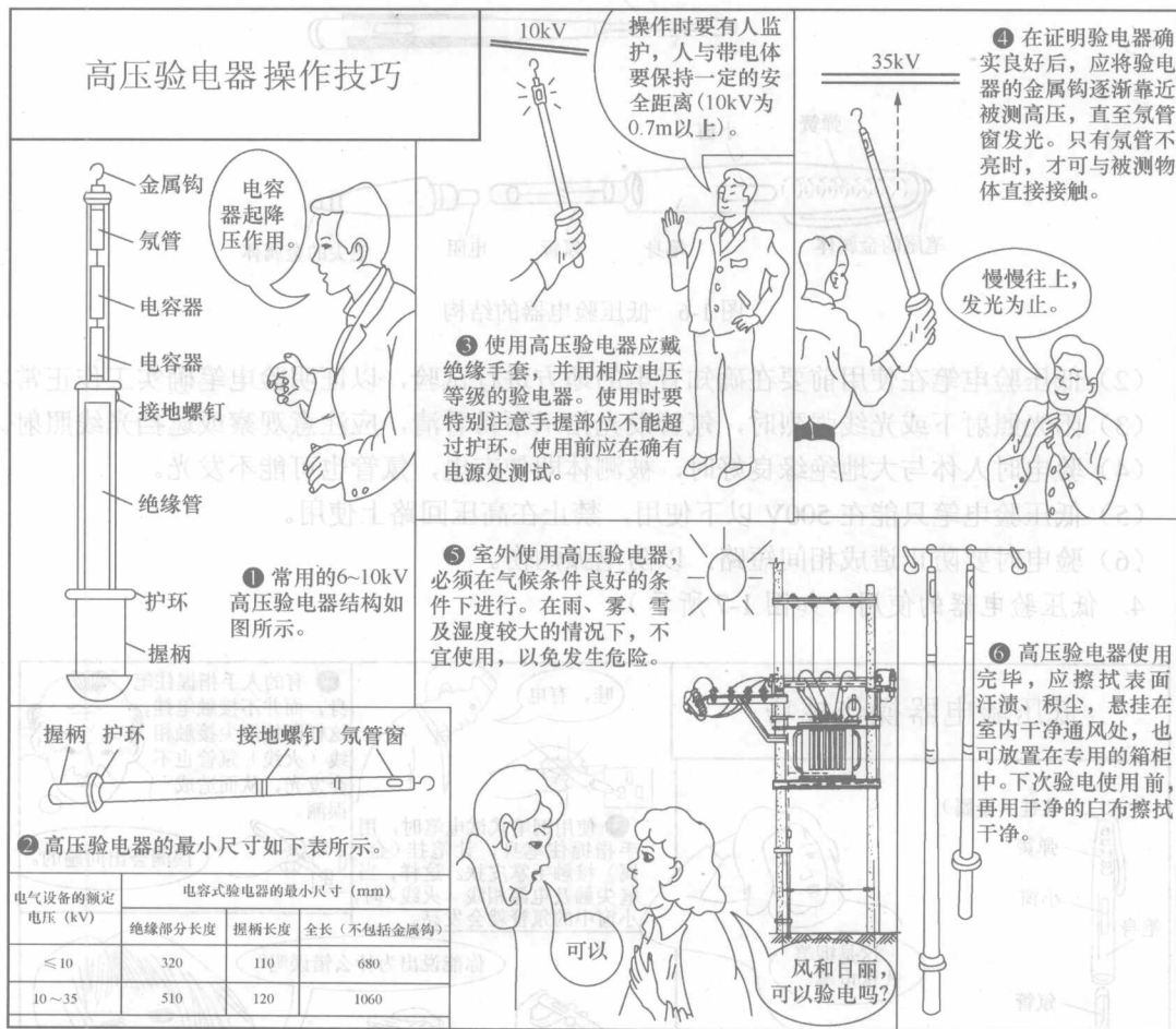
图 1-5 高压验电器的使用
