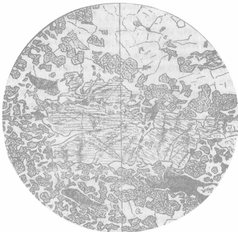
图7 后成合晶环(SA43--2)紫苏辉石(Hyp)被许多石榴石(Alm)和石英(Q)的小颗粒所环绕;单偏光 d=6\text{mm}
