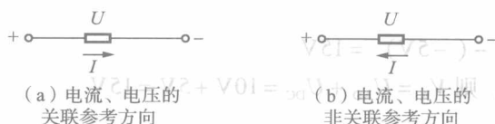
图 1-10 电流、电压参考方向的两种关系
