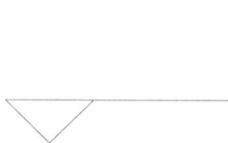
图 2-4 建筑图用 标高符号
