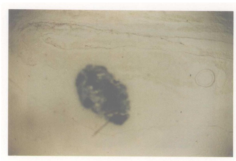
图 4.12 墨汁在低流阻通道内移动 2 cm 后所在部位的结构 黑点为原墨汁所在位置(30 ×)
