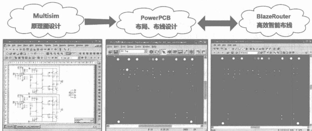
图 1-1-2 Multisim 结合 PowerPCB 进行 EDA 设计的流程
