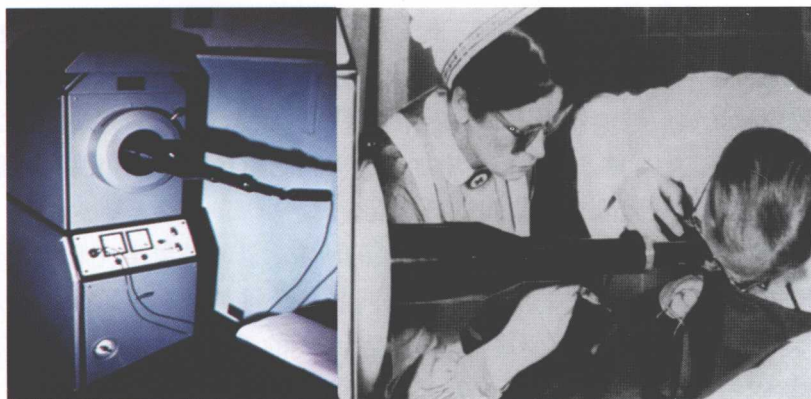
图2 左图是Zeiss公司生产的第一台眼底氩激光凝固治疗机 右图是发明者德国Essen大学Meyer-Schwickrath教授在使用这台设备治疗患者
