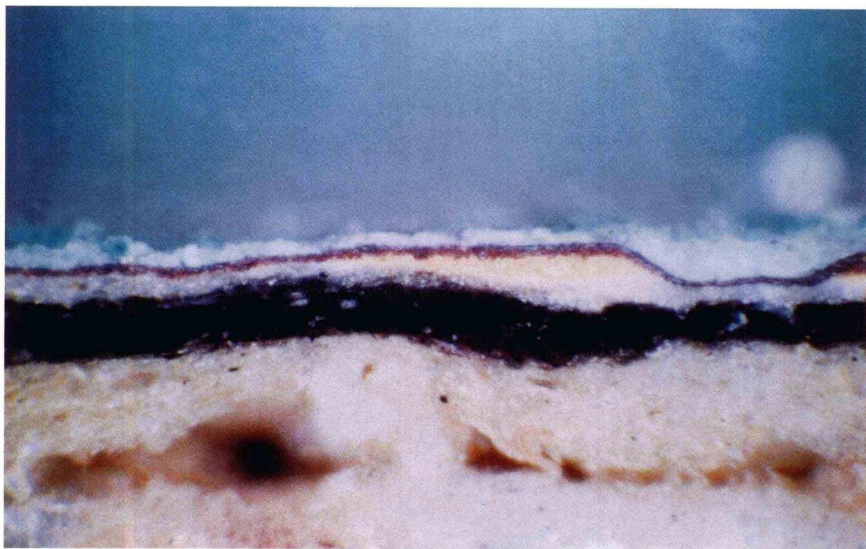
2. 炳灵寺唐代第130窟壁画中严重变色 \text{Pb}_3\text{O}_4 (一层黑色的 \text{PbO}_2 ) 横切面偏光显微镜照片 ( \times 200 )
